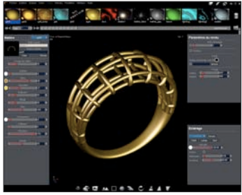
11- Application d'une texture aux volumes pour visualisation en temps réel des matières (Open GL)
