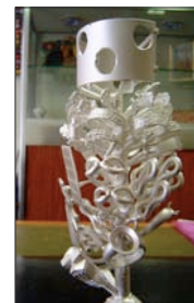
18- Récupération de la grappe en argent après la fonderie
